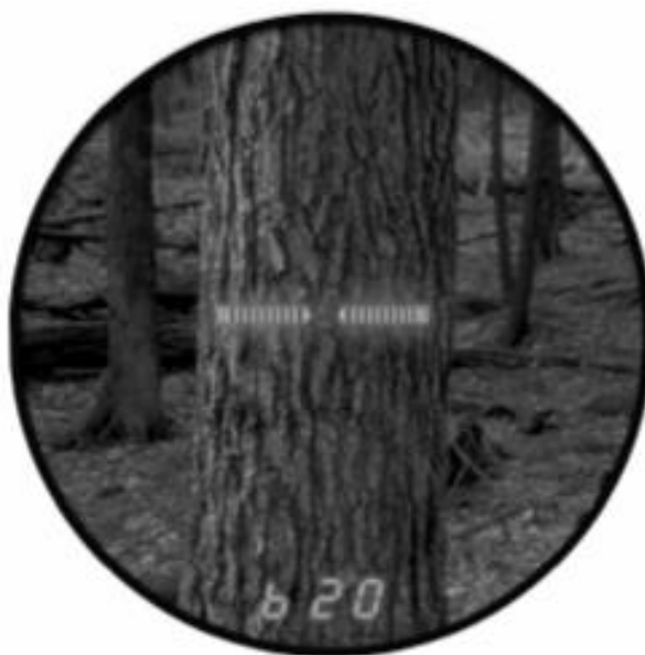
Figura 14. Esempio di misura di diametro attraverso la modalità DIAMETRO.
